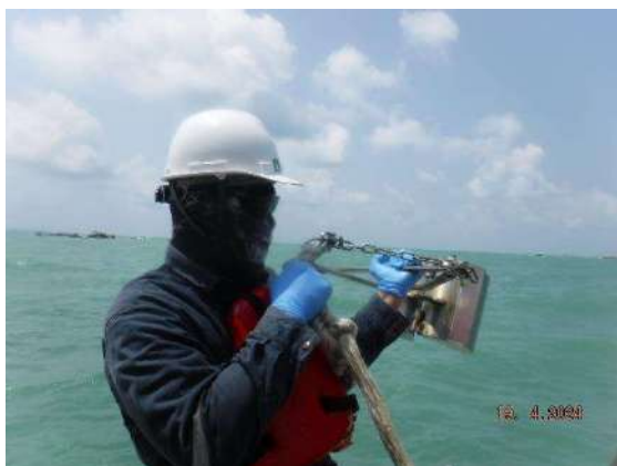
รูปที่ 3-27 การเก็บตัวอย่างสัตว์หน้าดิน (Benthos) ด้วย Petersen Grab Sampler
