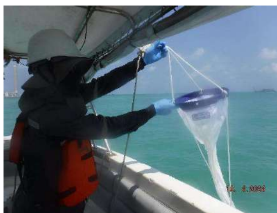
รูปที่ 3-26 การเก็บตัวอย่างแพลงก์ตอนด้วยถุงลากแพลงก์ตอน (Plankton Net)
