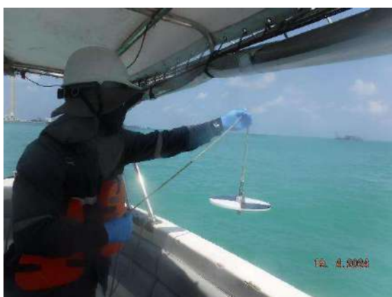
รูปที่ 3-25 การวัดค่าความโปร่งใสด้วย Secchi Disc
