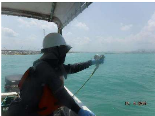
รูปที่ 3-14 การตรวจวัดระดับความลึกของน้ำทะเล ด้วย Depth Gauge
