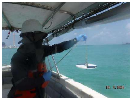
รูปที่ 3-15 การวัดค่าความโปร่งใสด้วย Secchi Disc
