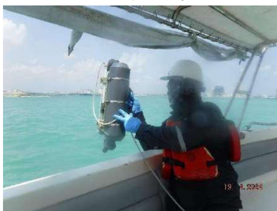
รูปที่ 3-16 การเก็บตัวอย่างน้ำทะเลด้วยเครื่องมือเก็บ ตัวอย่างแบบเทฟลอน
